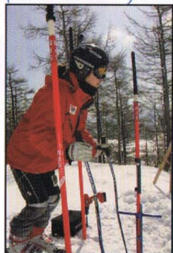
IE-01をレンチのやや上につけてください place the IE-01 somewhat higher than the gate key.
