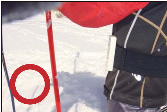
横からのイメージ 左側面にセンサーが（液晶が下）ついているので、ウェアやポールなどで隠れないよう装着してください
